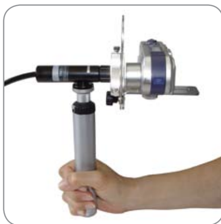
TMES con adaptador para cámara digital opcional. La cámara no se incluye
